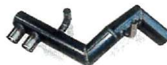
油圧配管パイプ \phi 114.3 角度切り
