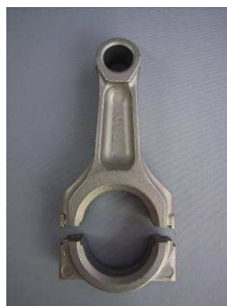
図.1-5 アルミダイカスト材 2ピース(ADC12)
