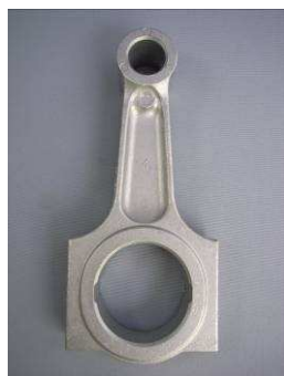
図.1-4 アルミダイカスト材 1ピース(ADC12)
