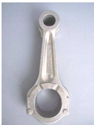
図.1-3 重力鑄造材 (AC2B-T6)
