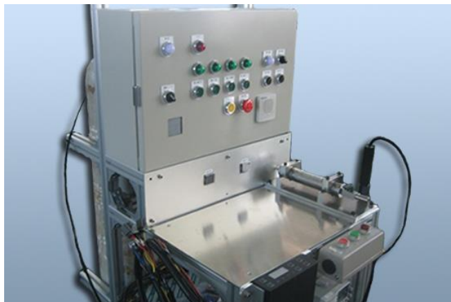
熱交換機用漏洩検査機（スニファー式） Sniffer type Leakage inspection device for heat exchanger
